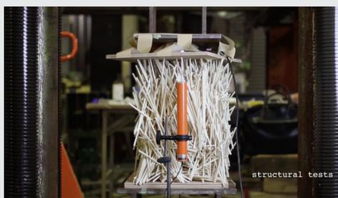
Prova di laboratorio a compressione
