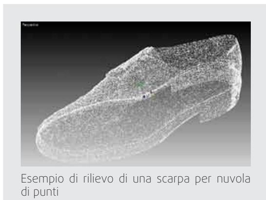
Esempio di rilievo di una scarpa per nuvola di punti
