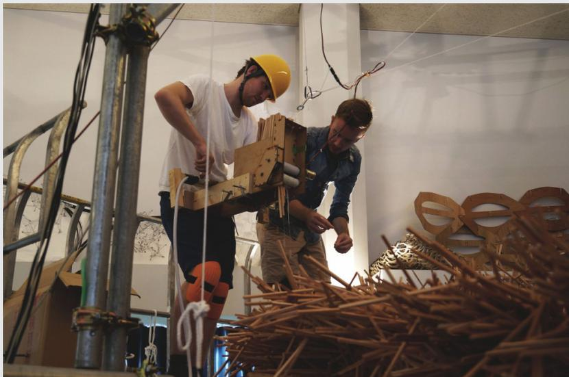
Macchina additiva per la deposizione delle asti in legno
