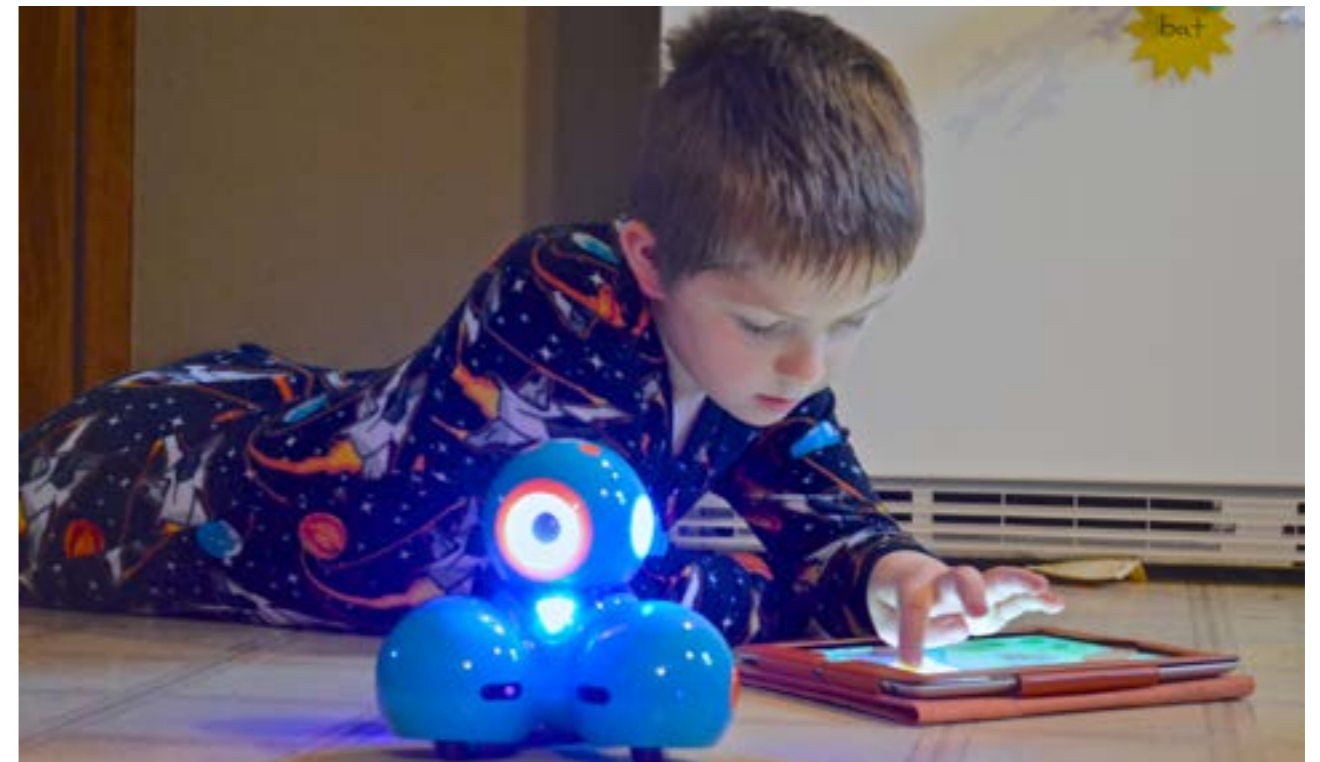
Esempio di robot programmabile tramite Blockly: Dash robot 158
