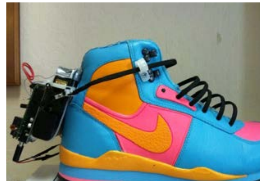
Scarpa autoallacciante prototipata con Arduino 211
