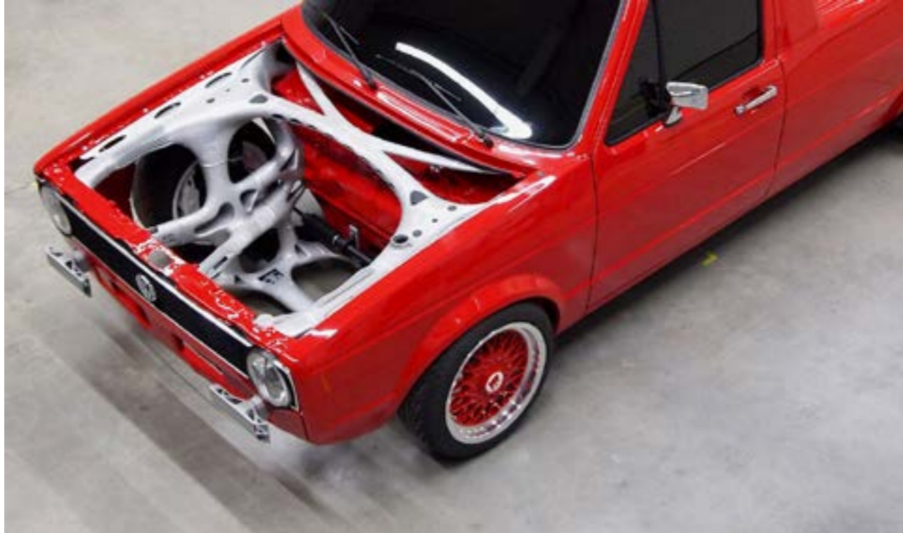
Sistema frontale di un'auto classica (Volkswagen Caddy) stampato in 3D 200
