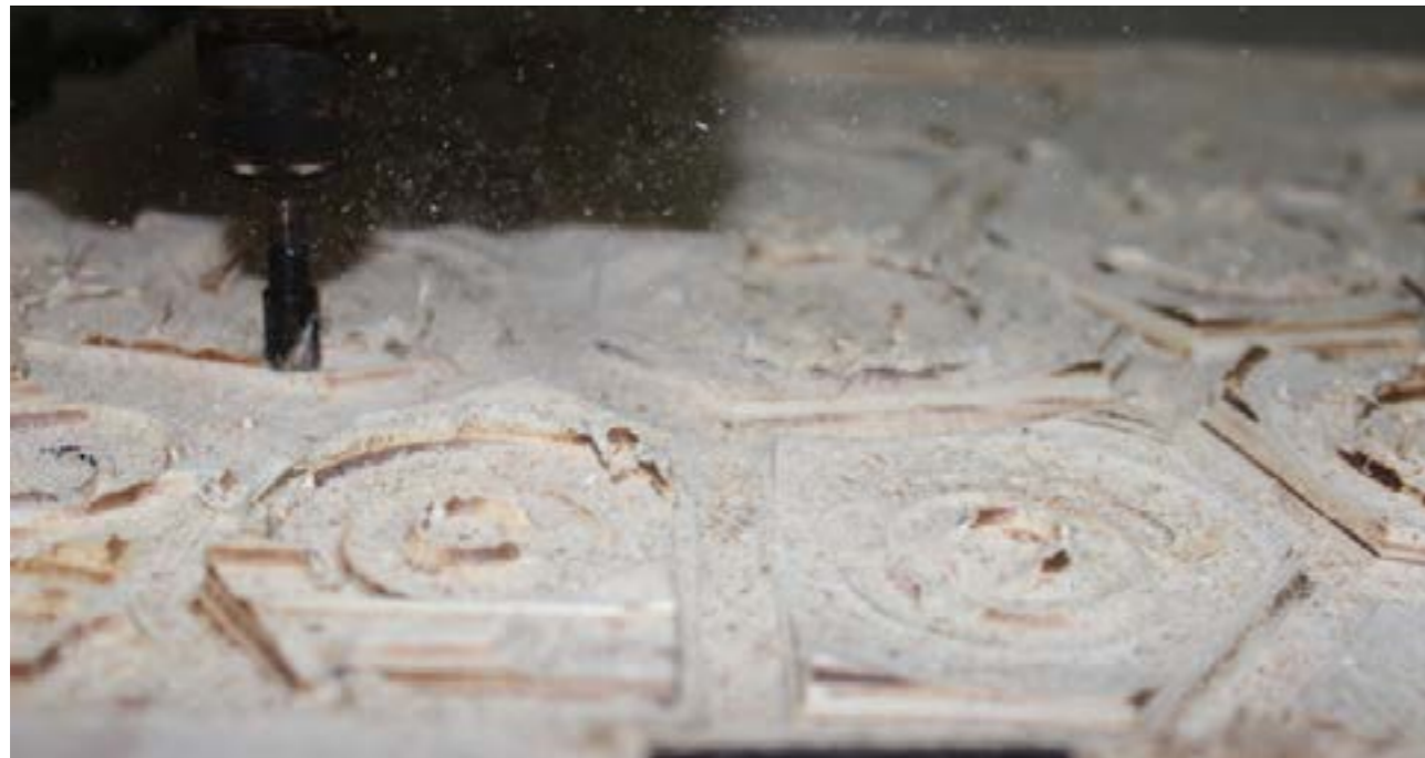
Esempio di sistema sottrattivo: Milling machine in funzione 24
